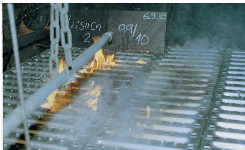
Obr. č. 3 - dole Požární zkouška zakrytí vany novými zhasčecími panely BP-H
