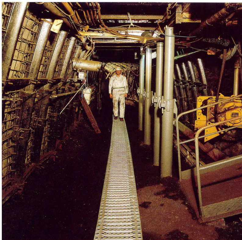
Obr. 1: Pochůzná lávka v chodbě dolu
